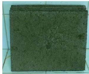
Figura 6. Tablero de aserrín-cemento con zeolita. 2013 (6)
