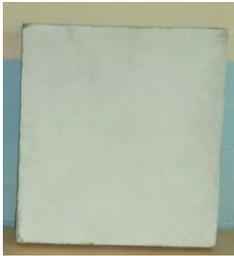
Figura 5. Panel de aserrín-cemento con zeolita. 2013 (5)
