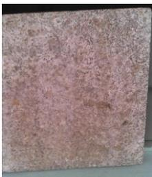
Figura 7. Tablero de aserrín-cemento. 2018 (7)
